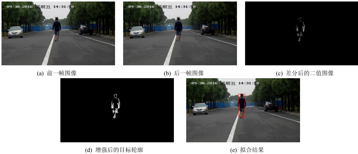
图8 基于机器视觉的目标检测结果
